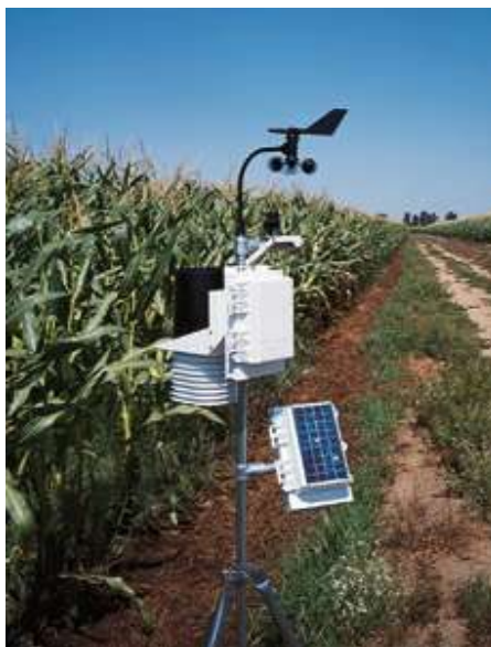
Figura 30. Estaciones Automáticas portátiles
