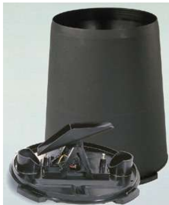
Figura 31. Pluviómetros automáticos con Datalogger
