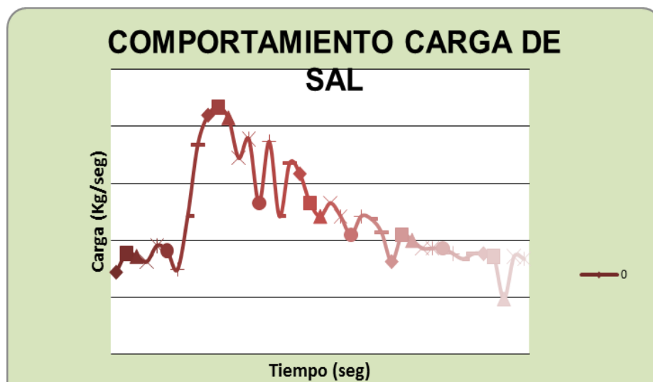
Figura 98 Resultado prueba de trazadores parte baja Río Pasto
