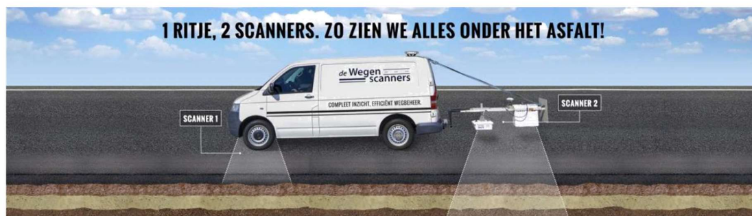
Figuur 1: Scanner 1 is de sensor voor natuurlijke achtergrondstraling, scanner 2 is de grondradar voor het meten van onder andere de constructieopbouw.
